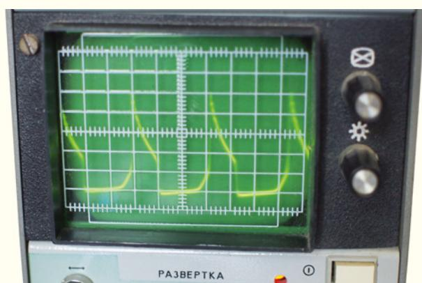
**ШАГ 4.** Вставьте в отсек батарею, напряжение на которой село до уровня 1,1 В, и с помощью осциллографа убедитесь, что импульсный преобразователь заработал. Контрольная точка – коллектор транзистора T1.
