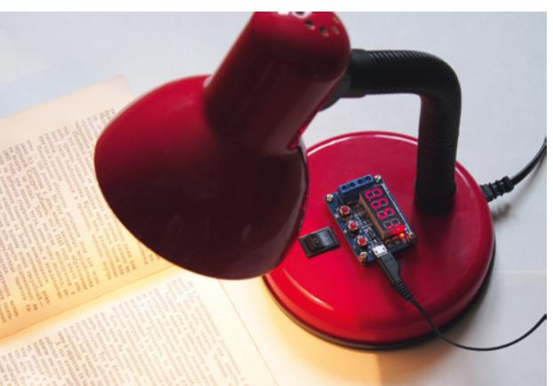
**ШАГ 4.** Опробуйте светильник в действии, подключив к нему 12-вольтовый блок питания и зарядное устройство от смартфона. Поочерёдно пересчитывайте ампер-часы в киловатт-часы. Желаем удачи!
