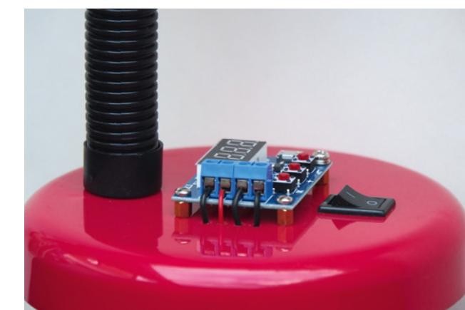
**ШАГ 2.** Закрепите счётчик на лампе. Присоедините к его клеммной колодке входные и выходные провода, соблюдая полярность. Выключатель питания должен быть подключён к тестеру.
