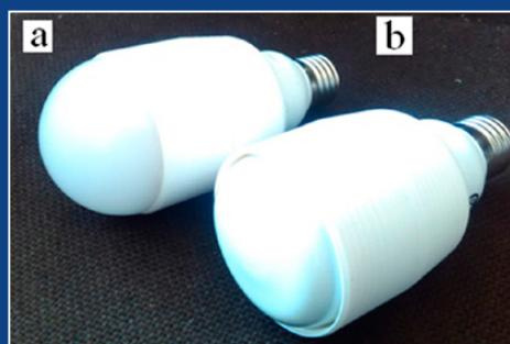
Рис. 3. Лабораторные прототипы катодолюминесцентных ламп со встроенным блоком питания на стандартном цоколе Е27 с рассеивателем (а) и без него (б).
