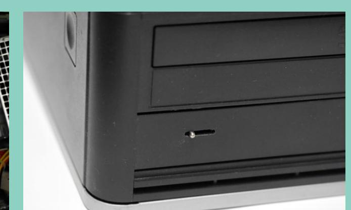
**ШАГ 6.** Прорежьте в пластмассовой крышке отсека щель, чтобы через неё вышел наружу рычаг тумблера. Испытайтте собранную конструкцию. Желаем удачи!
