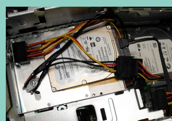
**ШАГ 5.** Вставьте собранную конструкцию в свободный 3,5-дюймовый отсек внутри системного блока. Подсоедините информационные и питание SATA-кабели.
