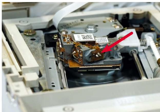
**2** Разберите накопитель, найдите каретку с головкой чтения-записи, а на ней – два лазерных диода. Определите, какой из них «красный». Аккуратно извлеките его вместе с теплоотводящей пластиной.
