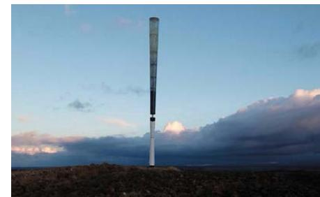
Разработчики делают ставку на простоту и дешевизну системы: в ней нет ни лопастей, ни подшипников, ни шестерней. Согласно данным компании, её изобретение позволит снизить производственные расходы на 53%, затраты на обслуживание – на 51%, на ремонт – на 80% в сравнении с традиционной ветровой турбиной той же мощности.
