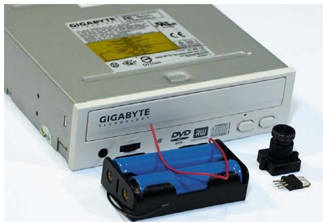
**1** Подберите всё, что потребуется: DVD-накопитель, два аккумулятора типоразмера 18650 с отсеком для них, микросхему LM317, резисторы, выключатель, паяльник, набор мелких отвёрток...
