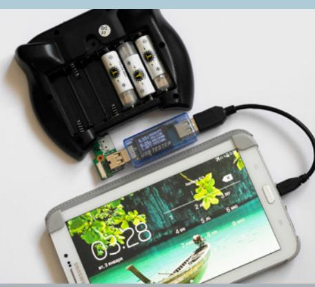
ФОТО 3. Измеряем ёмкость умных аккумуляторов с помощью USB-мультиметра
