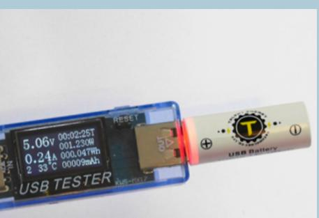
ФОТО 4. При заряде элемент потребляет от USB-источника около четырёх ампер
