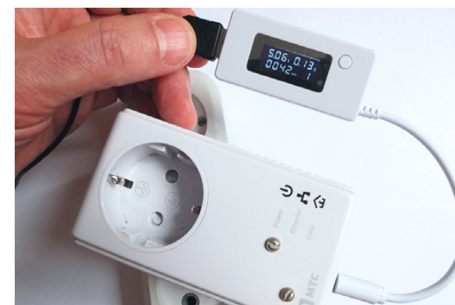
ШАГ 5. Через USB-разъём выведете напряжение с блока питания наружу. Чтобы преобразователь устойчиво работал на холостом ходу, подключите нагрузочное сопротивление R8. Проверьте стабильность напряжения.
