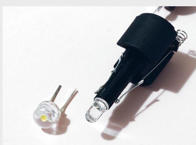
**Шаг 4.** Замените обычный светодиод на инфракрасный. Во избежание перегрева пластмассы при пайке крепко держите выводы пинцетом у основания корпуса.
