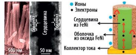
Для изготовления электродов были выбраны весьма недорогие материалы – железо-никелевый сплав и его окись. При этом, как выяснилось, ключ к успеху – нанопровода. На коллекторе тока (для этой цели в экспериментах использовалось золото) были сформированы структуры из нанопроводов диаметром 50 нм, которые имели сердцевину из сплава и оболочку из его оксида.
