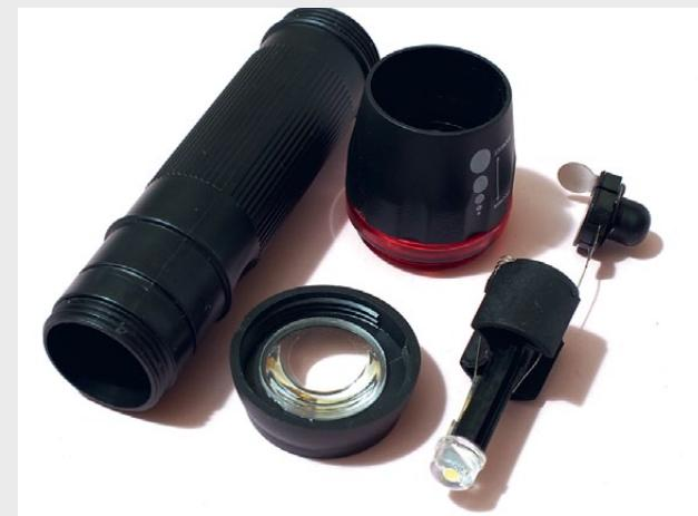
**Шаг 2.** Разберите фонарик на части, отвинтив линзу и рефлектор. Аккуратно выньте держатель со светодиодом. Запомните последовательность разборки.
