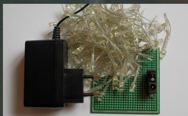
**1** Соберите всё, что Вам понадобится: светодиоды от сломанной гирлянды, блок питания на постоянное напряжение 12 В, макетную плату, разъём с выключателем, инструменты (здесь не показаны).
