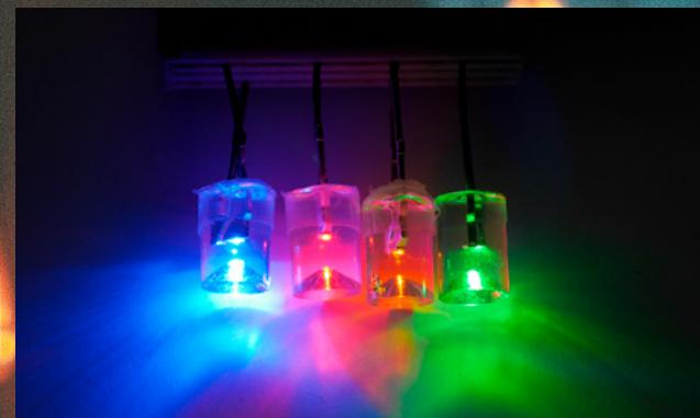
**2** Освободите выводы светодиодов от изоляции и рассортируйте их по цветам с помощью 12-вольтового блока питания и балластного резистора примерно на 1 кОм.
