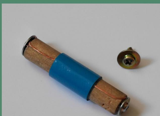
**ШАГ 2.** Изготовьте заглушку типоразмера AA из деревянной палочки, провода и пары шурупов. Подберите шурупы с выступающими головками.
