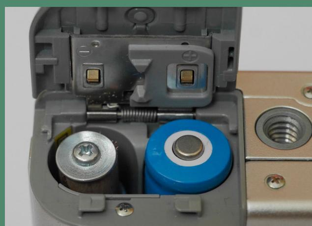
**ШАГ 3.** Вставьте ионно-литиевый аккумулятор и заглушку в батарейный отсек выбранного устройства. По возможности проверьте контакты.
