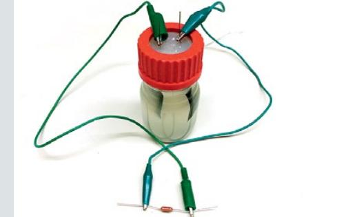
Гибрид топливной ячейки и аккумуляторной батареи вырабатывает и тут же запасает электроэнергию
