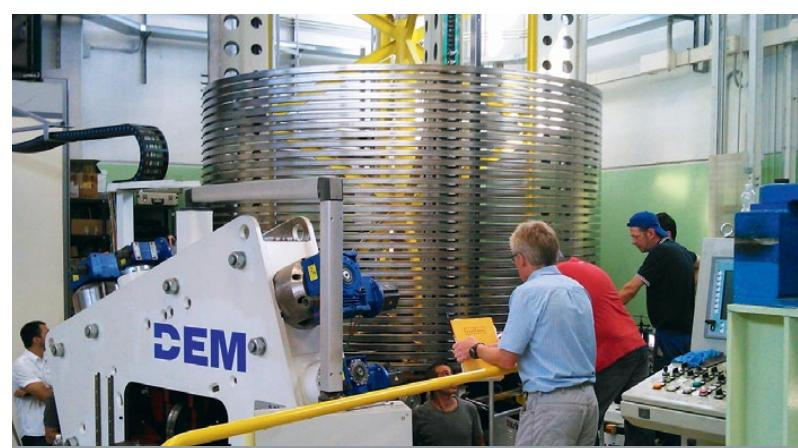
Сверхпроводящая катушка для термоядерного реактора ITER
