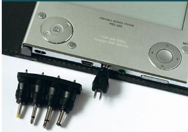
**5** Прежде чем подключать зарядное устройство, проверьте полярность и значение напряжения на выходе разъёма с помощью мультиметра.
