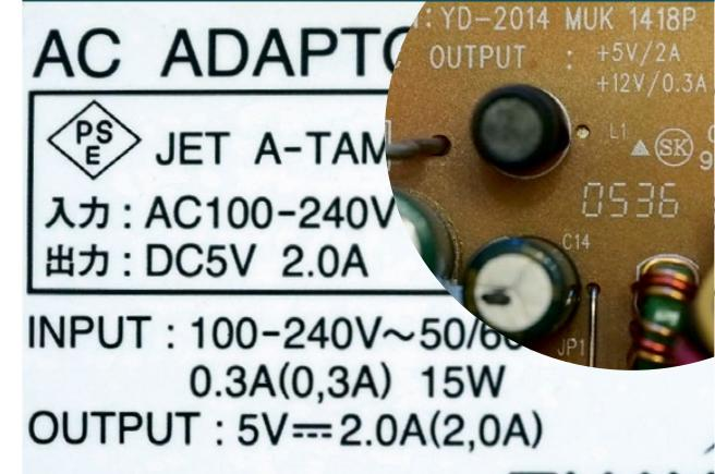
**4** Найдите разъём, подходящий к электронной книге, например, в наборе переходников для гаджетов. Припаяйте его к выходу блока питания.
