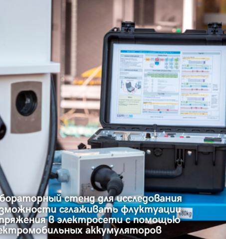
Лабораторный стенд для исследования возможности симулировать флюктуации напряжения в электросети с помощью электромобильных аккумуляторов
