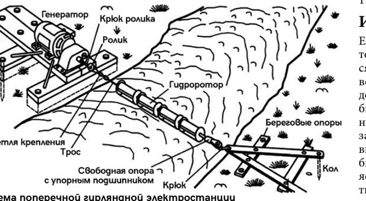
Чтобы трос вращался равномерно, Блинов решил закреплять роторы парами, развернув их один относительно другого по оси на 90°. Роторы в парах должны были находиться на таком расстоянии, чтобы не задевать друг друга, когда трос выгибался дугой. И, кроме того, нужно было учесть, что при скручивании троса укорачивается.
