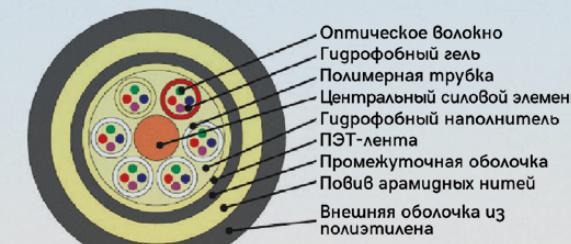
Рис. 2. Конструкция кабеля ОКСН марки ОКК
