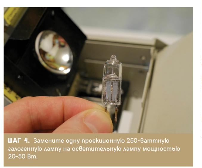
ШАГ 4. Замените одну проекционную 250-ваттную галогенную лампу на осветительную лампу мощностью 20-50 Вт.
