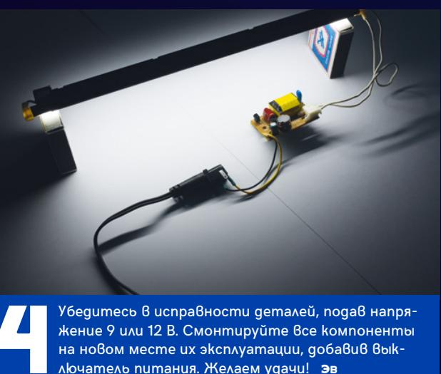
4 Убедитесь в исправности деталей, подав напряжение 9 или 12 В. Смонтируйте все компоненты на новом месте их эксплуатации, добавив выключатель питания. Желаем удачи! **ЭВ**
