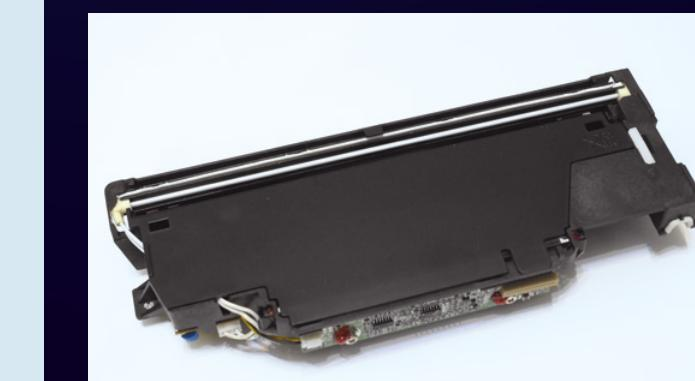
2 Извлеките из сканера чёрную каретку, которая перемещается внутри корпуса. Найдите на ней длинную тонкую люминесцентную лампу и плата преобразователя. Крышка каретки может быть приклеена или прикреплена винтами. Будьте осторожны: лампа хрупкая!
