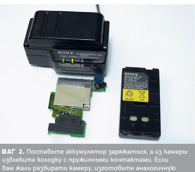
**ШАГ 2.** Поставьте аккумулятор заряжаться, а из камеры извлеките колодку с пружинными контактами. Если вам жаль разбирать камеру, изготовьте аналогичную колодку самостоятельно.
