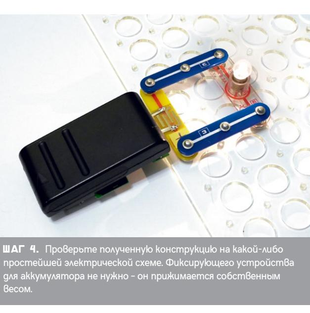
**ШАГ 4.** Пробуйте полученную конструкцию на какой-либо простейшей электрической схеме. Фиксирующее устройство для аккумулятора не нужно – он прижимается собственным весом.
