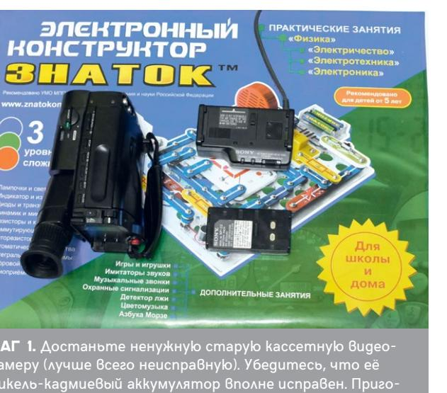
**ШАГ 1.** Достаньте неиспользованный старый видеокамеру (лучше всего неисправную). Убедитесь, что её никель-кадмиевый аккумулятор вполне исправен. Приготовьте паяльник и другие инструменты.
