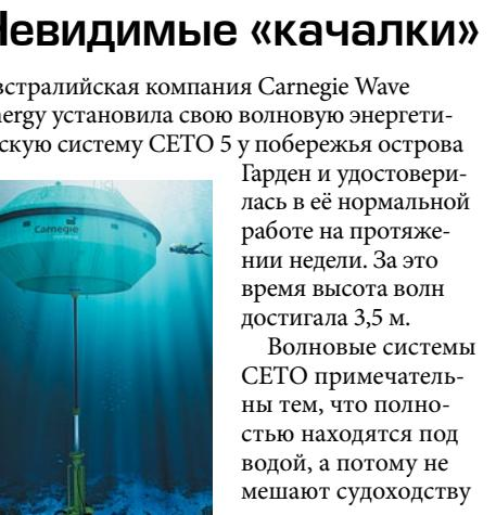
Волновые системы СЕТО примечательны тем, что полностью находятся под водой, а потому не мешают судоходству и не портят вид моря. Подвешенные под водой эластичные резервуары воспринимают колебания давления от проходящих над ними волн, преобразуя эти колебания в напор воды с помощью донных насосов. От них морская вода поступает по трубопроводу на берег, где приводит в вращение стартартные гидрогенераторы.
