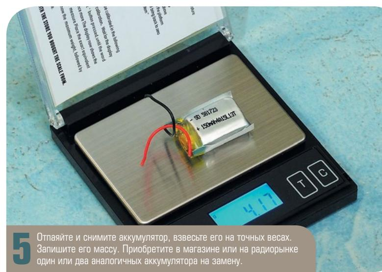
**5** Отпаяйте и снимите аккумулятор, взвесьте его на точных весах. Запишите его массу. Приобретите в магазине или на радиофоруме один или два аналогичных аккумулятора на замену.
