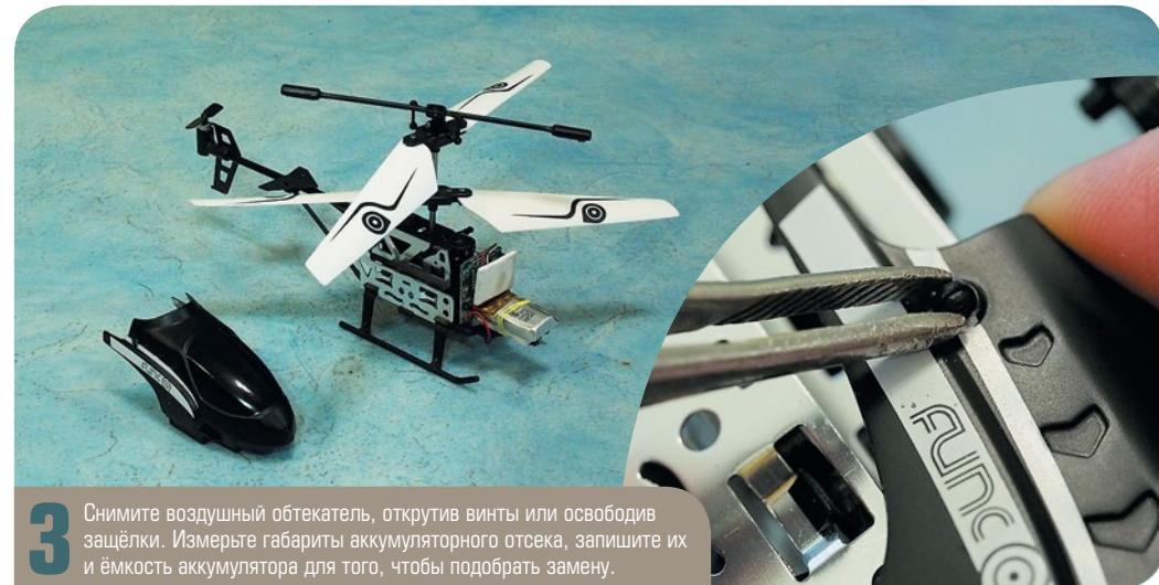
**3** Снимите воздушный обтекатель, открутив винты или освободив защёлки. Измерьте габариты аккумуляторного отсека, запишите их и ёмкость аккумулятора для того, чтобы подобрать замену.
