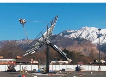
тром около 5 м, в фокусе которого подвешены четырёхцилиндровый теплоакустический свободнопоршневой двигатель Стирлинга с линейными электрическими генераторами.
